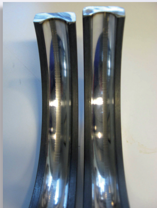
Een wentellagerloopbaan met stroomschade
